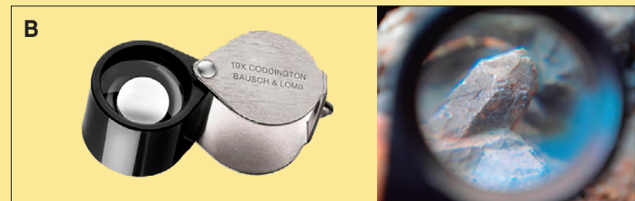
Figura B. Izquierda: Lupa de 10 aumentos. Derecha: Visión aumentada de pequeño grano mineral
