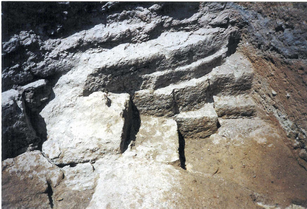
Figura 8.- Cantera de época romana con las huellas de extracción de los sillares (cortesía F. Blanco).
